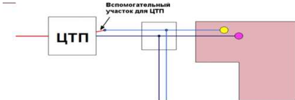
Рисунок 3.5 – Подключение трубопровода ГВС
